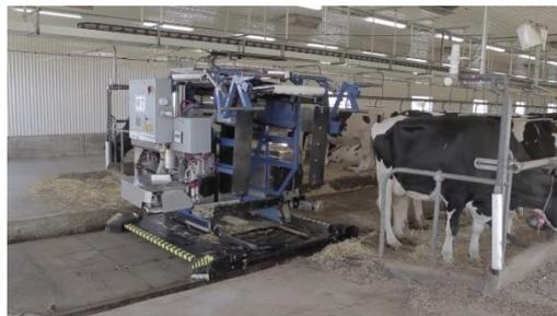
Figure 8. Robot de traite mobile en étable entravée [42]
