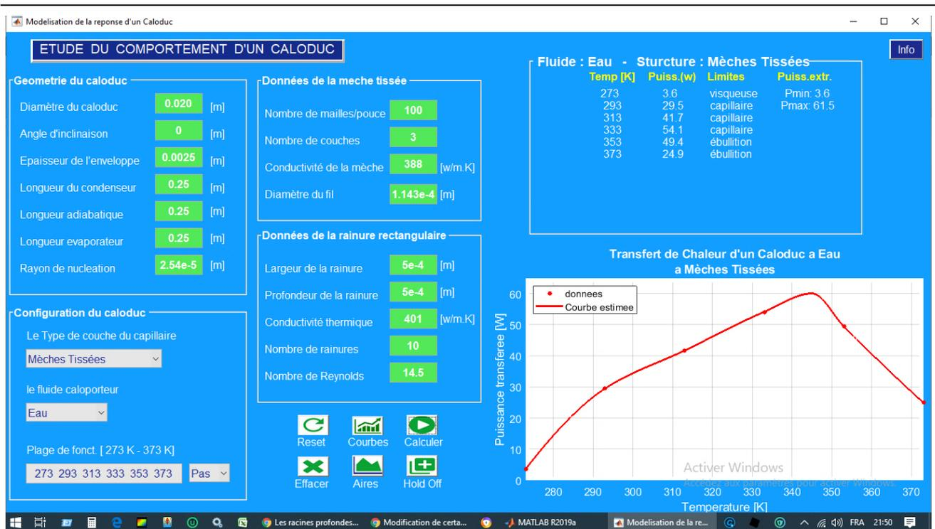
Figure 4. Interface graphique du modèle élaboré pour le caloduc.
