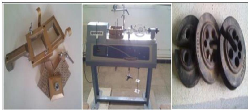
Figure 10: essai de cisaillement à la boite.
