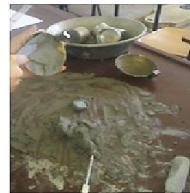
Figure 03 : Essai des limites d'Atterberg sur le schiste.
