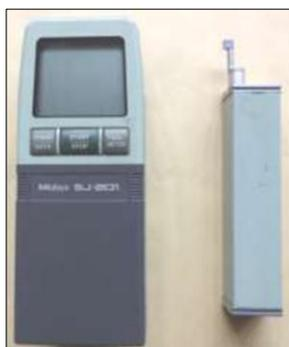
Figure 3. Rugosimètre SurfTest Sj201
