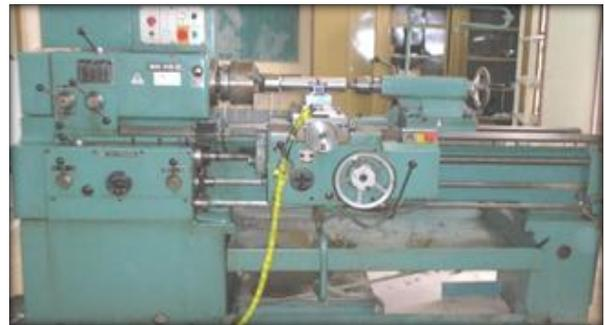
Figure1. Tour parallèle modèle SN40C.
