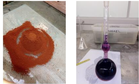
Figure 2. Absorption des grains de sable et de déchet de brique par le kérosène.
