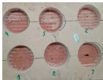
Mortier 2 (25 % DB)/ Interface du support 70 % détachement au support
