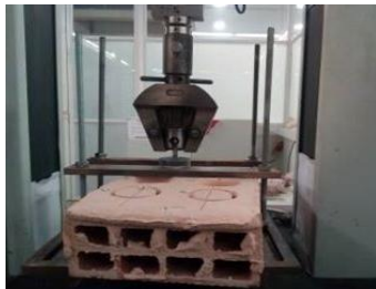
Figure 6 : Dispositif de l'essai d'adhésion
