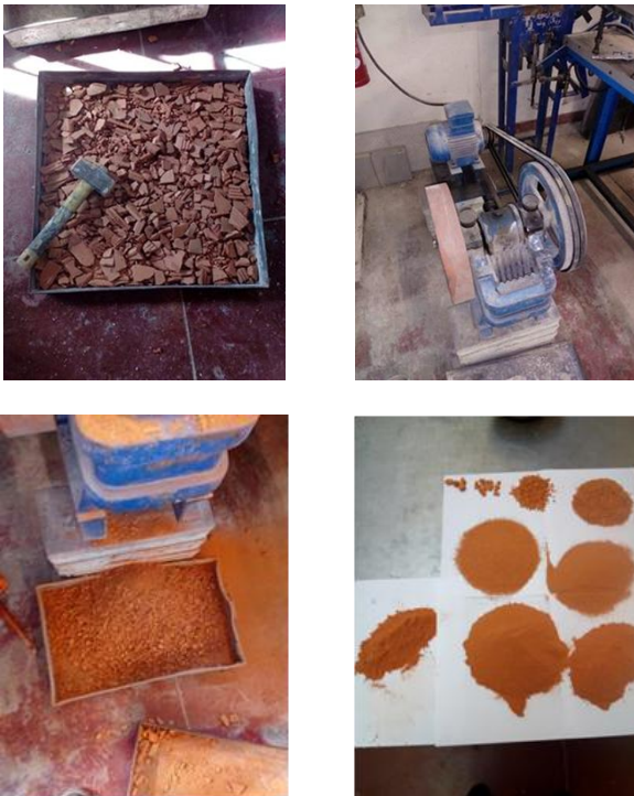
Figure 1. Fabrication du déchet de brique en terre cuite et l'appareil de concassage utilisée.
