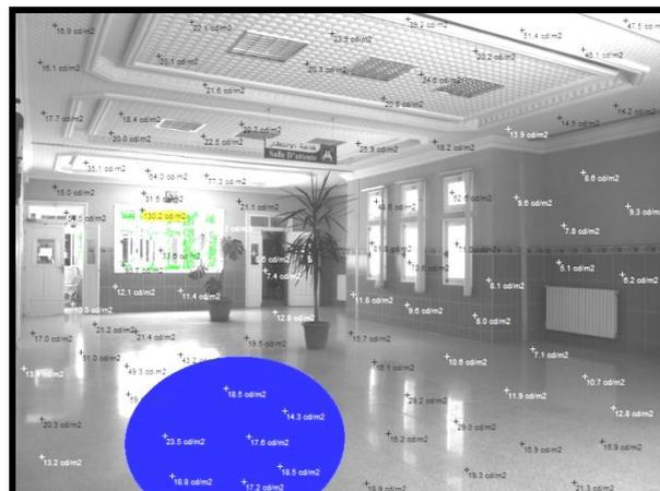
Figure 5. Carte des luminances du hall d'accueil et d'attente de l'hôpital Ain-Azel générée suite à la simulation d'une photo HDR à l'aide des logiciels DAYSIM / EVALGLARE et RADIANCE IMAGE VIEWER. (Source : Auteur)
